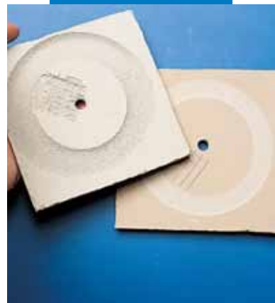
Abrasão Taber realizada com Ultraplan (provete à direita) e argamassa de regularização convencional (provete à esquerda) após 200 rotações
